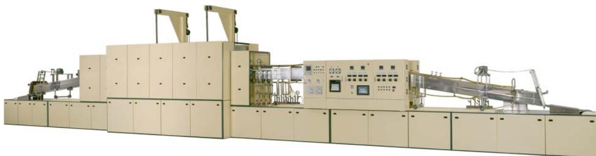
写真 1 連続式水素炉(18m:ハンプバック型)の外観
