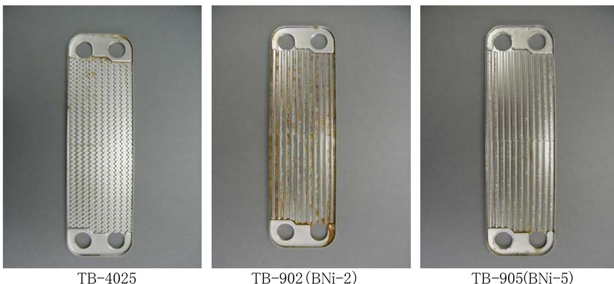
図 5 塩水噴霧試験後の各試験片外観
